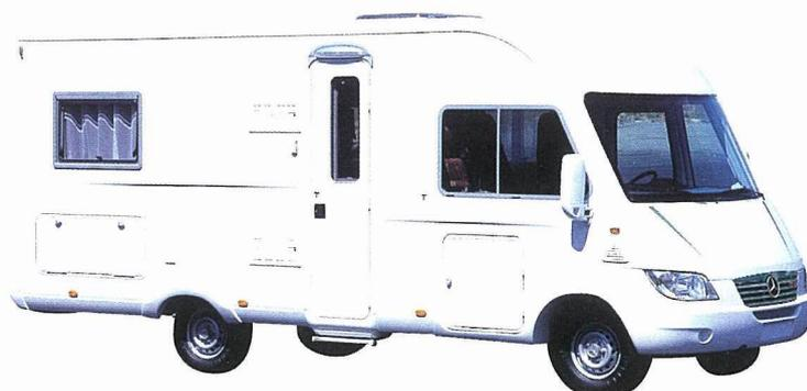
**Capucine** : facilement reconnaissable avec son avancée abritant deux couchages au dessus du poste de conduite, il est construit sur la base d'un châssis-cabine fourni par le constructeur automobile.
