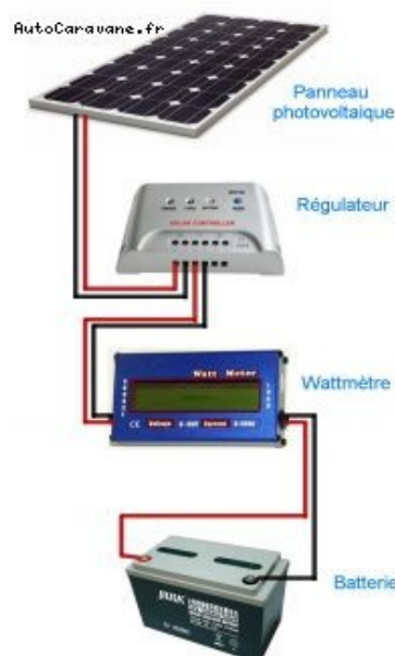
Schéma 1: Mesure de la production d'un panneau solaire
