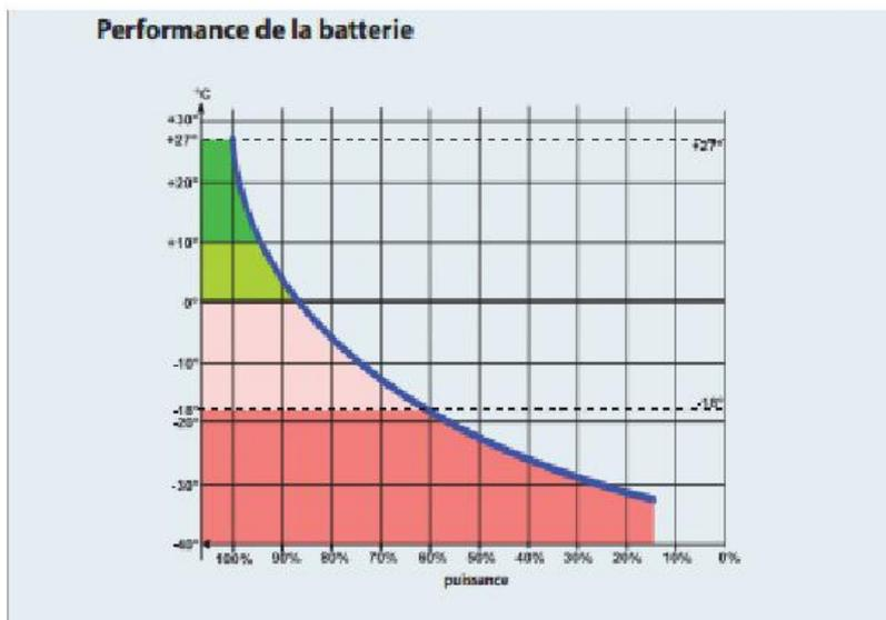
La température est donc déterminante pour les performances de la batterie, pour cette raison il faut qu'elle soit placée dans un endroit bien aéré.
