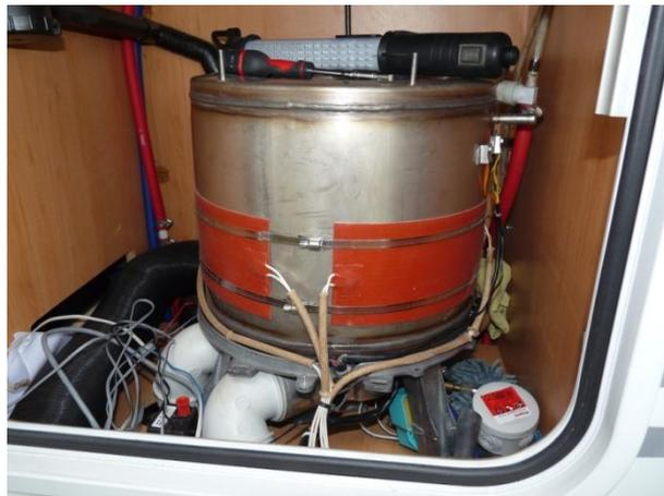
Reste à mettre en place la sonde du régulateur de température , que je positionne près des sondes Truma , à l'aide d' un support que j' ai confectionné ; Le fil de la sonde sera rallongé de façon à ce qu'il arrive au tableau de contrôle de la cellule
