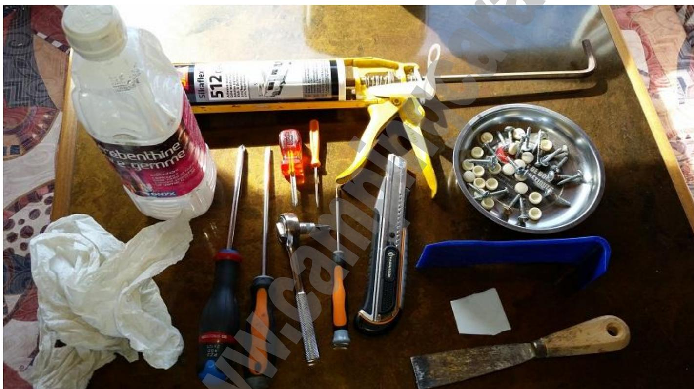
1 cartouche de Sika 512 (utilisée entièrement pour une grande baie), tournevis cruciforme (+ tom pouce ou bien douille pour dévisser derrière les placards haut) tournevis plat + raclette acier pour nettoyer le dormant, cutter + raclette plastique pour couper et gratter le mastic sur cellule, essence de térébenthine + chiffon pour nettoyer les déchets de joints, une paire de tréteaux.
