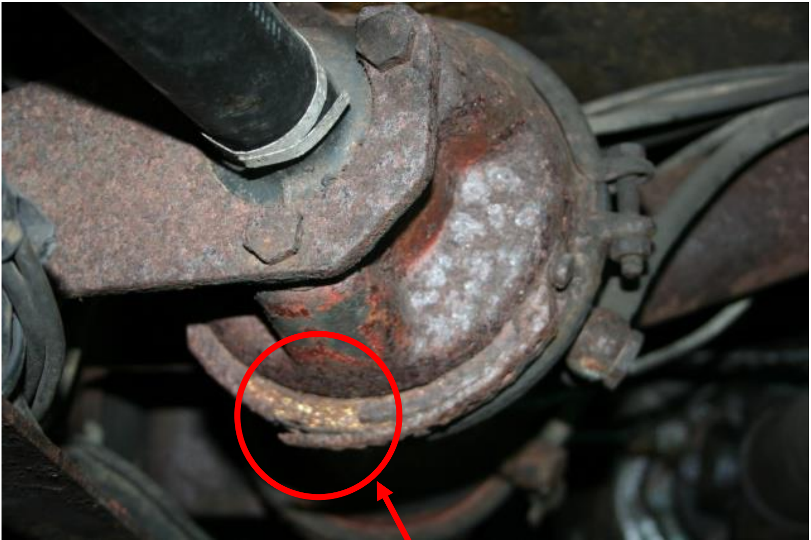
Oxydation d'un cylindre de frein.
