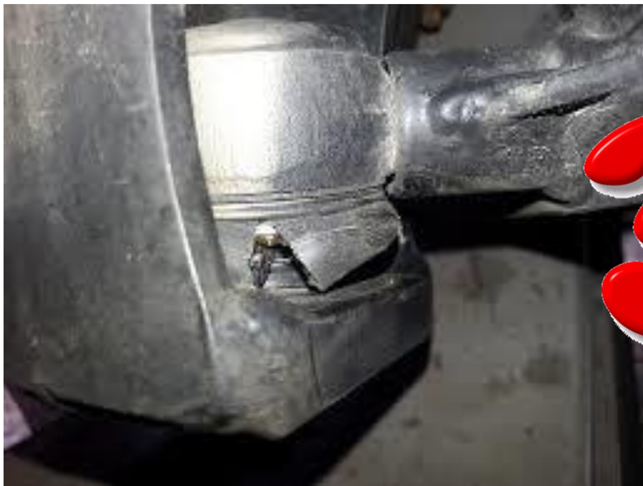
Rotule de suspension avant
