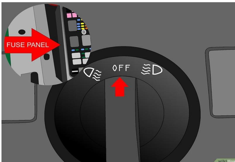
**7- Vérifiez en détail le circuit et les appareils protégés par ce fusible.** Débranchez, les uns après les autres, les ampoules, les résistances, les appareils (lecteur CD, par exemple) pour trouver l'origine de la fuite.
