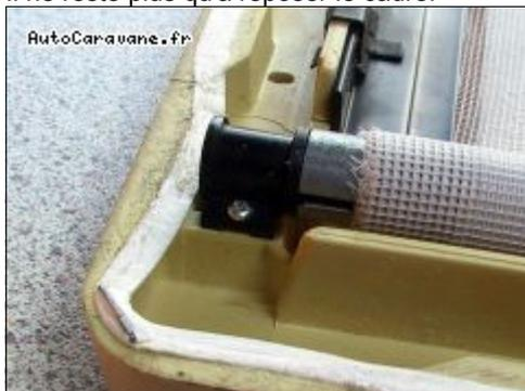
Tout d'abord, vérifier que le palier n'est pas posé à l'envers (voir photos: à gauche, montage incorrect, à droite montage correct).
