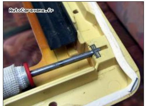
A la main, tourner le bout d'axe aplati: il entraîne un ressort. Le tourner à la main pour le mettre en tension, et le repositionner sous les agrafes. Revisser le palier. Faire un essai en mettant le cadre vertical: la toile s'enroule énergiquement? Oui, bravo; Sinon, renouveler l'opération en tournant davantage la tige du ressort (environ 15 à 25 tours en tout).
