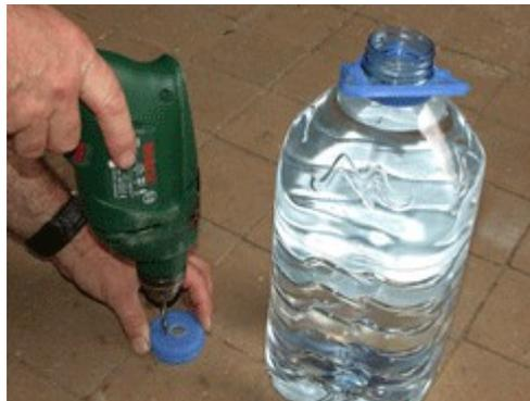
**Passer le tuyau dans le bouchon.** Si le trou est un peu grand, il faudra faire un joint au silicone de préférence à l'intérieur du bouchon.
