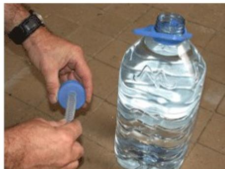
**Brancher le tuyau sur la pompe.** Il n'est pas nécessaire de le fixer avec un collier, d'autant que ce dernier risque de s'oxyder après un certain temps passé dans l'eau.
