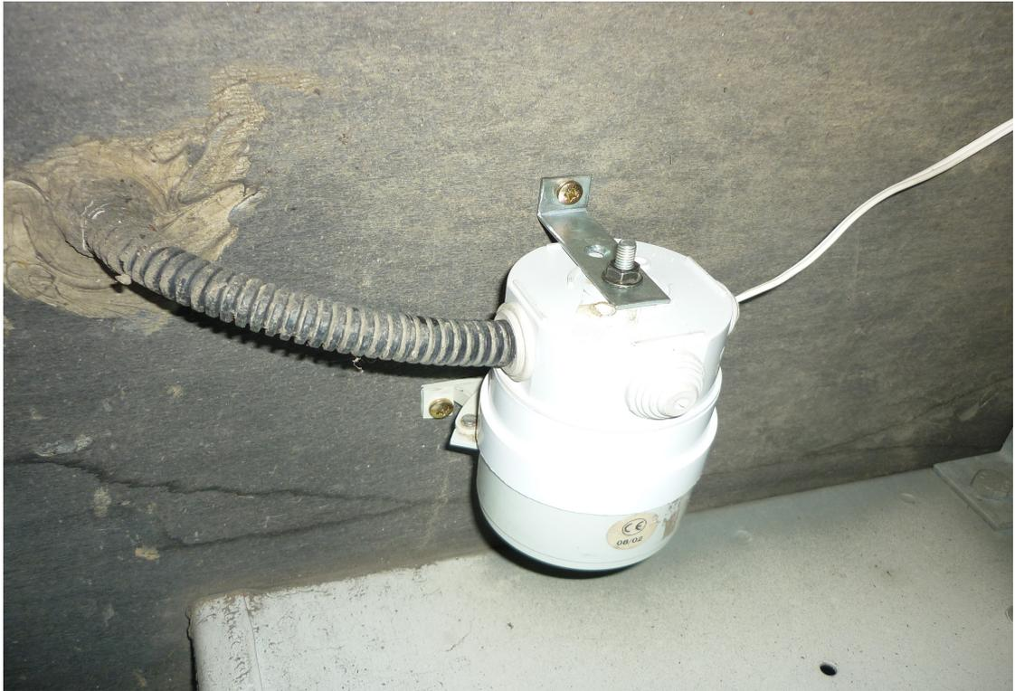
**l' ensemble est simplement bridé par les pattes de fixation sous le châssis, et utilise la gaine d' évacuation déjà existante ici à gauche**
