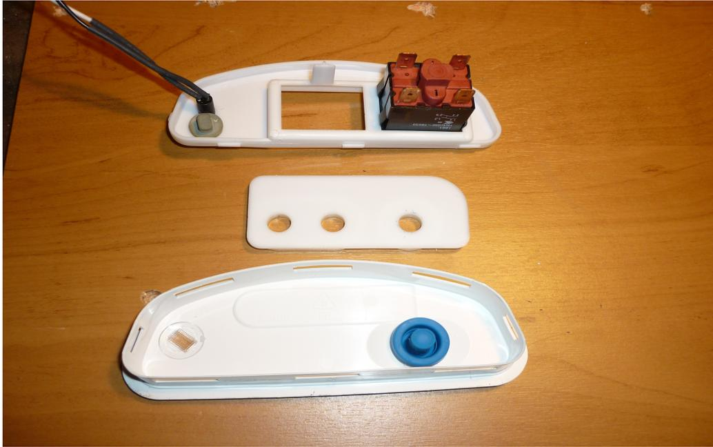
à gauche la led de trop plein cassette, à droite le poussoir de rinçage cuvette en eau
