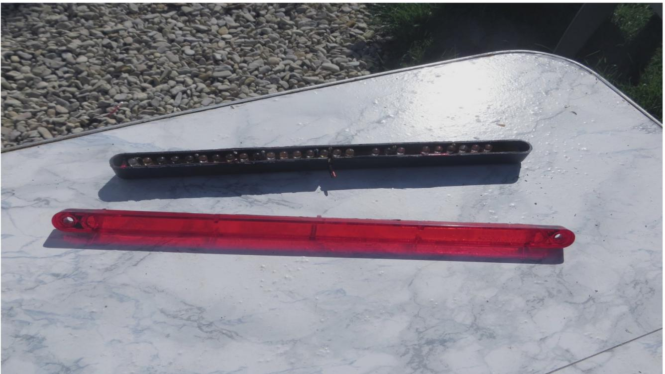
**Dans le fond du compartiment récepteur du feu, j'ai collé une bande led étanche, après l'avoir raccordée aux fils d'arrivée:**
