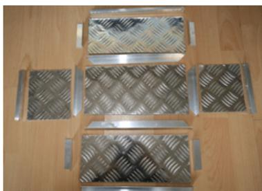
**Confectionner un boîtier pour protéger l'évacuateur** : découper les cinq panneaux (en fonction des dimensions de l'appareil) dans une plaque d'aluminium, ainsi que les cornières pour les angles.
