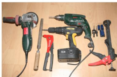
**Boîte à outils** : Un tournevis cruciforme, un tournevis plat (électrique), une perceuse, une meuleuse, une pince à riveter, une lime, un pistolet à colle-mastic, un jeu de trépons pour le métal.
