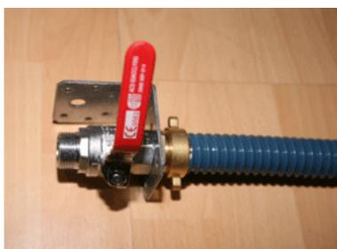
**Principe de montage** : visser la réduction 20/27 – 26/34 mâle-mâle sur le pas de vis femelle de la vanne en intercalant l'équerre entre les deux. Enduire le pas de vis du raccord avec de la colle mastic qui assurera l'étanchéité et le blocage de la pièce. Le tuyau d'évacuation sera relié avec le raccord 26/34..
