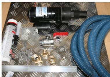
**Inventorier le matériel nécessaire** : un évacuateur, du tuyau de 40 mm et un de 25 mm, une plaque et de la cornière en alu, des rivets, du mastic, une vanne en 20/27 mâle/femelle, une équerre métallique, deux raccords en laiton et leurs colliers (un 26/34 et un 20/27), une réduction 20/27 – 26/34.
