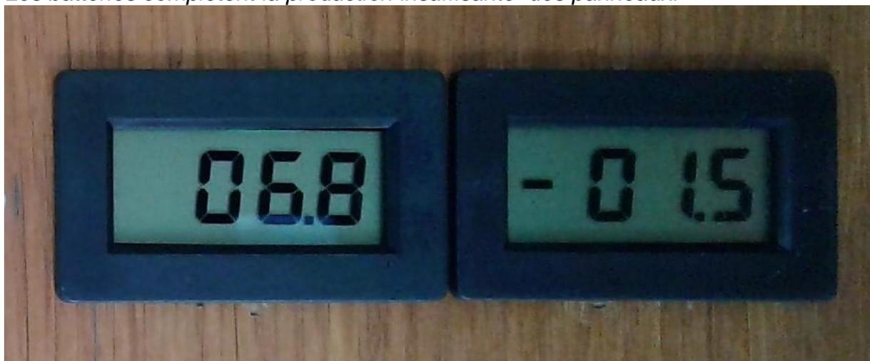
En soirée, l'indicateur de gauche passe à 0 car les panneaux ne produisent plus, et l'indicateur de droite indique avec le signe – l'intensité de décharge des batteries. Cette indication peut aider à gérer la consommation.
