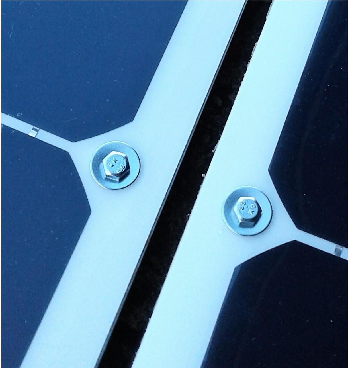
*l'ensemble posé sur le toit du camping car, vissé sur les barres de galerie.*
