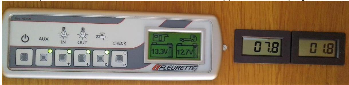
Sur la photo ci-dessous prise dans des conditions différentes, on constate que les panneaux fournissent 6,8A, et que les batteries se déchargent à raison de -1,5A. Les batteries complètent la production insuffisante des panneaux.
