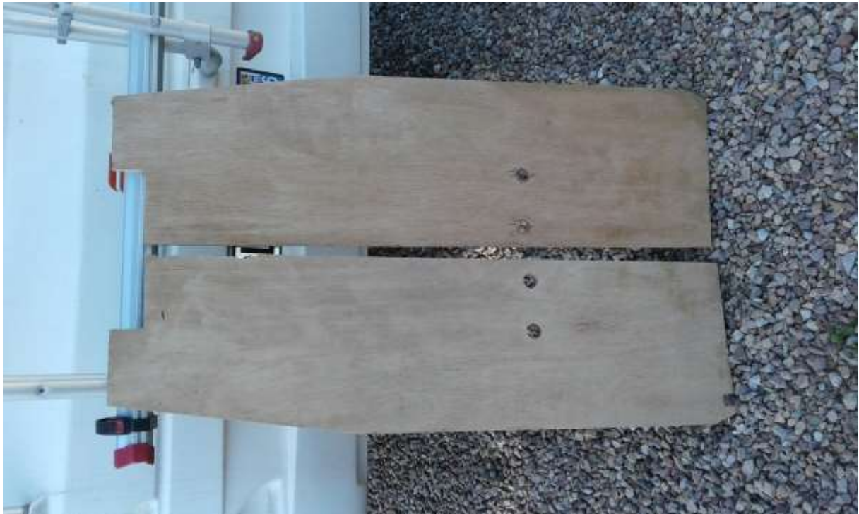
Les joues, détails des perçages et fraisages pour loger les vis et têtes de vis du chassis Alko
