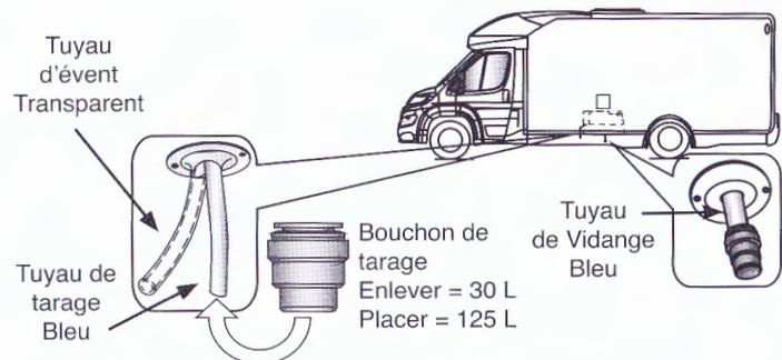
Pour mettre le bouchon il suffit de l'enfoncer en entièrement sur le tuyau. Pour enlever le bouchon.
