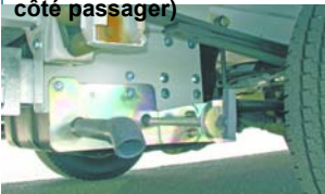
Vanne d'évacuation des eaux usées (derrière la jupe de bas de caisse)
