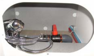
Vanne d'évacuation des eaux usées (dans la soute arrière du double plancher côté passager)
