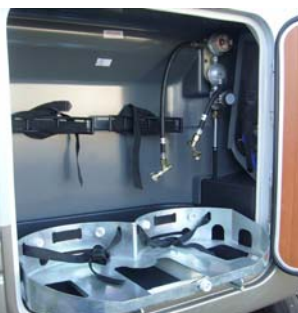
On peut stocker deux bouteilles dans le coffre à gaz
