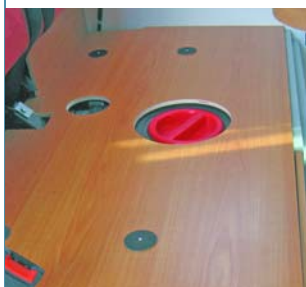
Trappe de visite du réservoir d'eau propre
