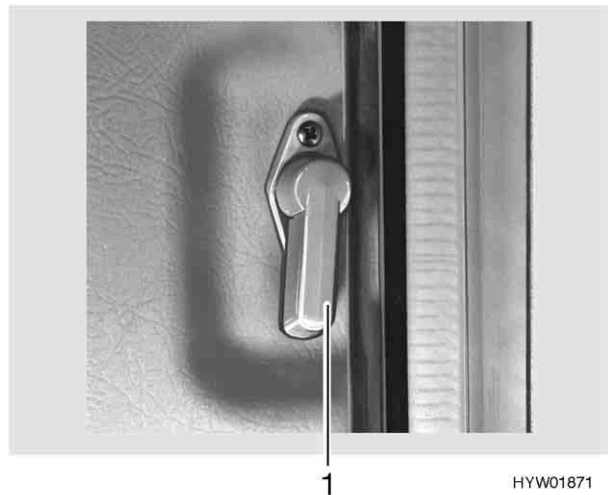
Image 19 Levier de verrouillage de la porte, partie supérieure de la porte
