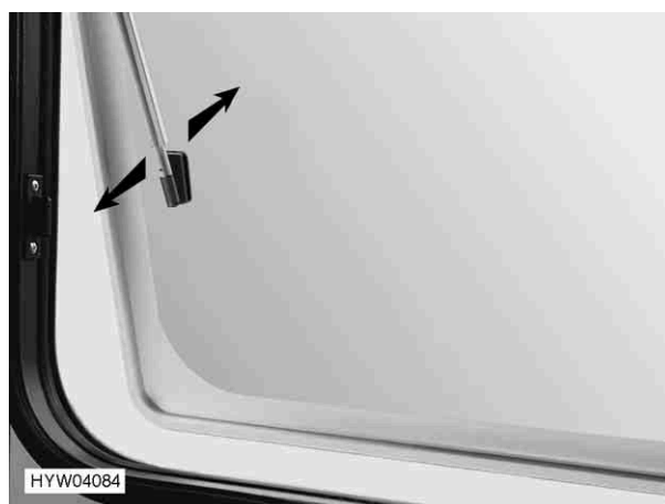
Image 24 Fenêtre orientable, rail télescopique
